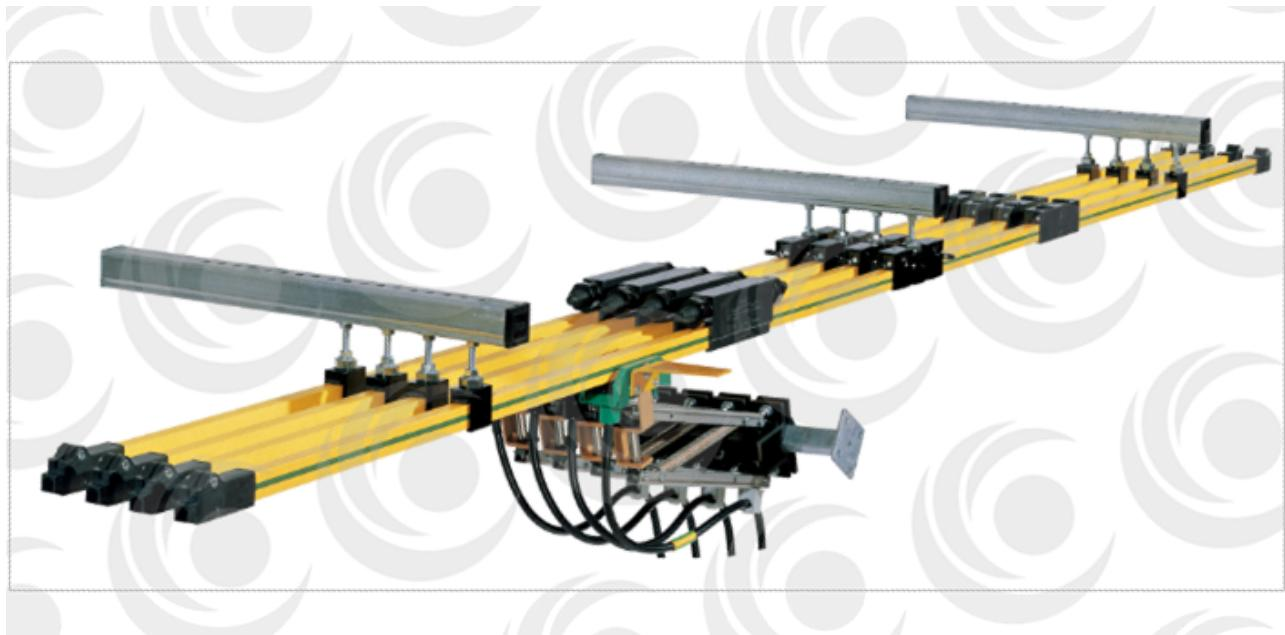
多极紧凑式滑触线MultiLine 0835 2极滑触线适用于有限空间的直线轨道。特点:组成部件少，易于快速高效安装；采用插入式爪型紧固件可实现预安装；紧凑型设计；系统长度和极数易于扩展；两级结构和中空型材实现高硬度；提供两个相线或者一点一地的组合。标准应用数据:额定电流 (滑触线) [A]: 100 额定电流 (系统) (100% ED) [A]: 32 电压 [V]: 48 AC/DC, 500 AC 滑触线长度 [mm]: 4.000 外形尺寸 [mm]: 38 x 98 工作条件:室内；轨道配置:直线轨道。角钢滑触线售后服务在使用寿命内 Conductix-Wampfler (康稳) 滑触线将为您更大限度地降低总体成本。
